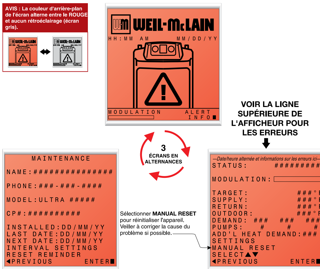
Figure 4 L'afficheur du U-Control vire au rouge lorsque la chaudière se verrouille — sélectionner MANUAL RESET (réinitialisation manuelle) pour réinitialiser la chaudière comme indiqué ci-dessous.
