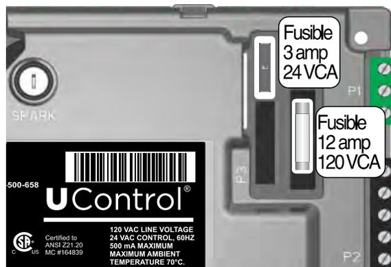
4. Au besoin, remplacer le fusible :
