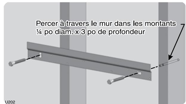
Figure 47 Placer la chaudière sur le support de fixation mural
