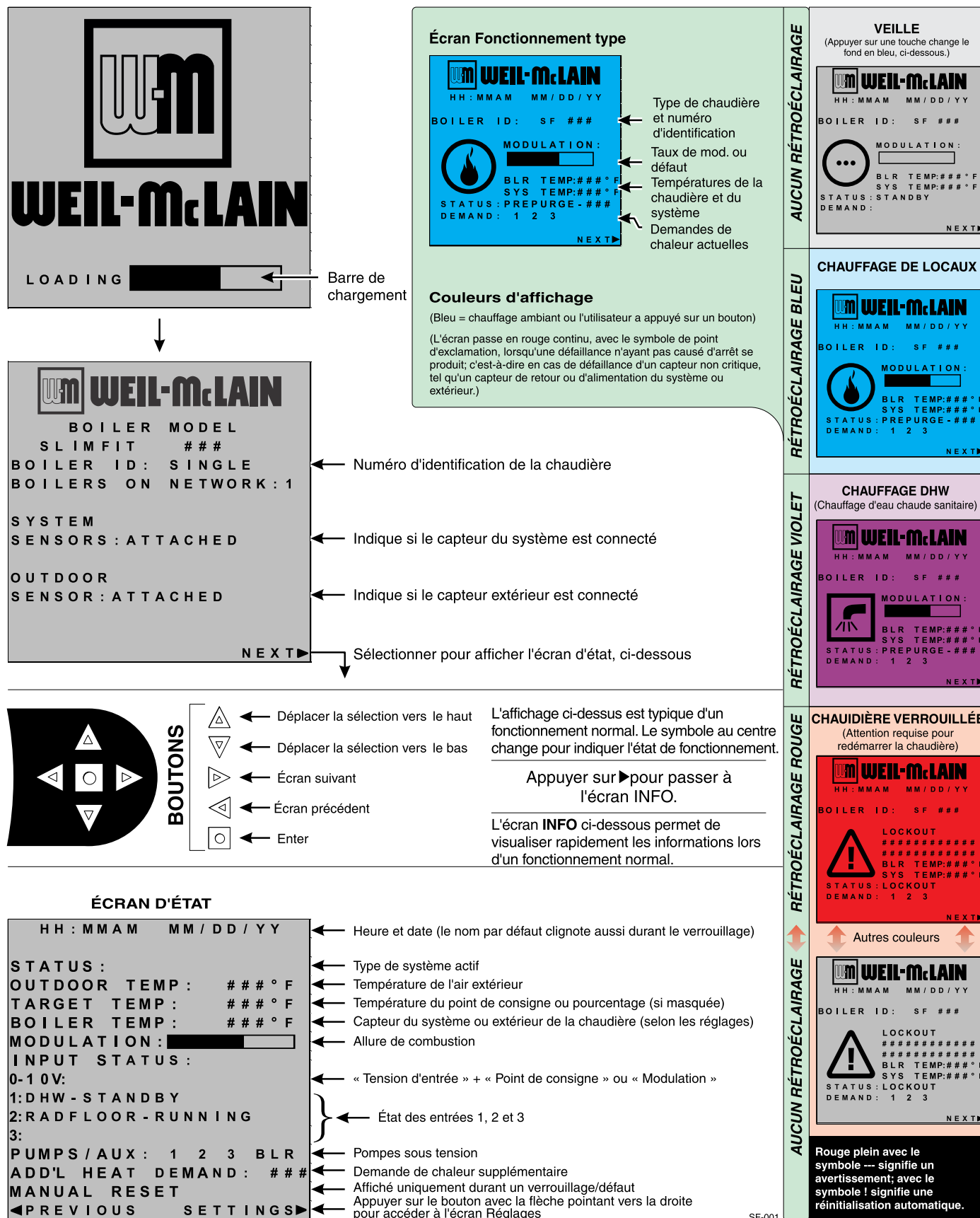
Figure 5 Afficheur du module de commande de la chaudière SlimFit
