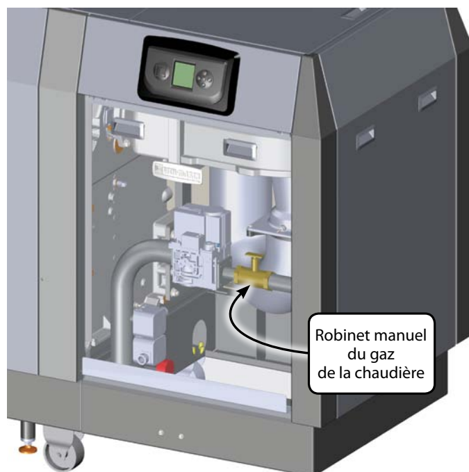
Figure 3 Robinet manuel du gaz de la chaudière, configuration de chaudière gauche, afficheur à montage en façade (l'afficheur peut être situé ailleurs sur le panneau d'accès côté brûleur)
