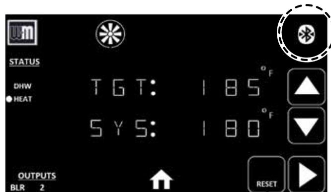
Figure 140 Connexion Bluetooth activée/désactivée
