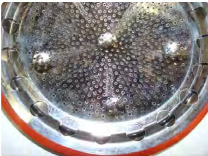
6. Inspecter l'intérieur du brûleur. Brosser et aspirer l'intérieur au besoin pour retirer de la peluche ou des sédiments. Autre méthode de nettoyage • souffler de l'air ou de l'azote de l'intérieur vers l'extérieur; • nettoyer avec un vaporisateur d'eau depuis l'intérieur du brûleur; • bien agiter le brûleur dans un seau d'eau et de détergent à lessive liquide doux, puis bien le rincer. Utiliser UNIQUEMENT une brosse non métallique.
