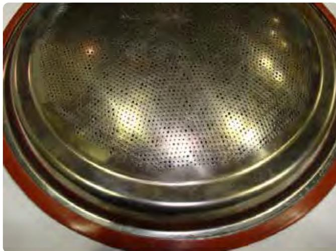
7. Inspecter l'extérieur du brûleur. Il doit être en bon état, sans dommage visible.
