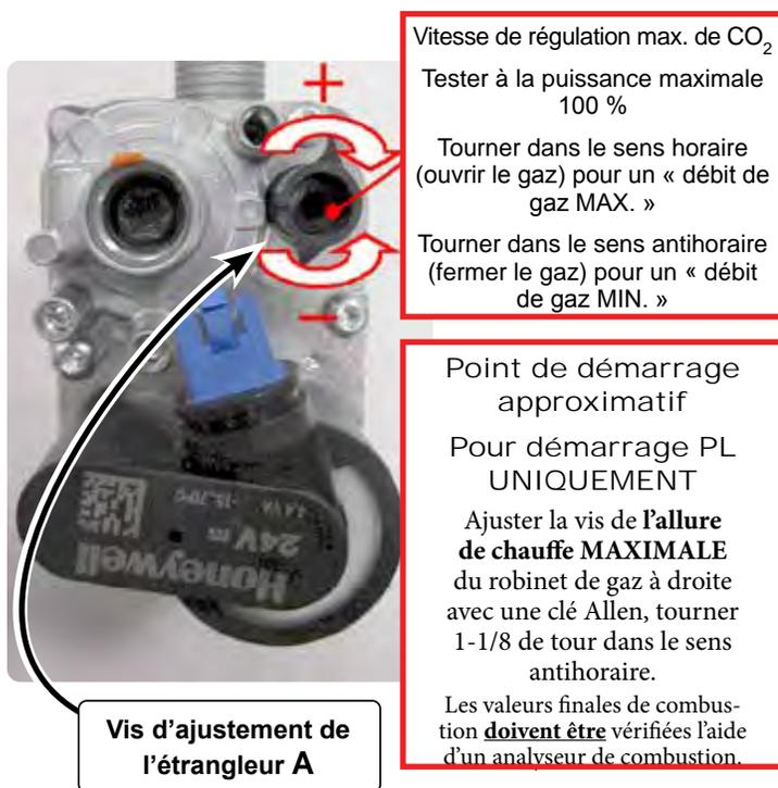
**Figure 107** Valeur de combustion à l'allure de chauffe maximale – les valeurs mesurées doivent être dans les plages données ci-dessous
