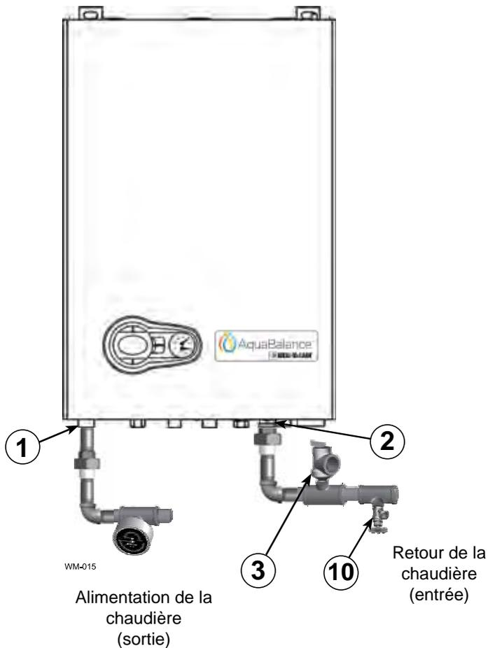
**Figure 6** Installer les composants de la tuyauterie requis pour l'essai hydrostatatique (voir la légende ci-dessous)
