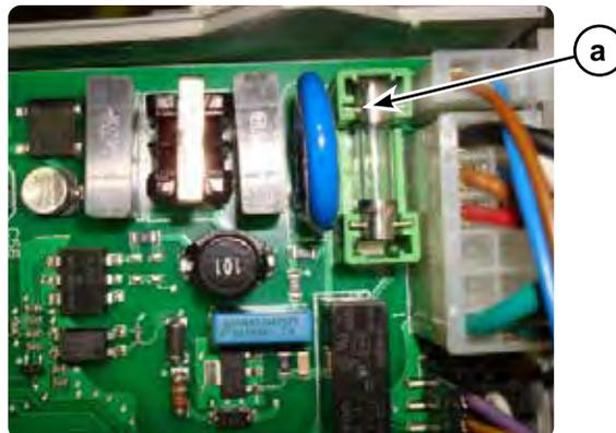
**Figure 116** Emplacement du fusible du circuit du thermostat-relais
