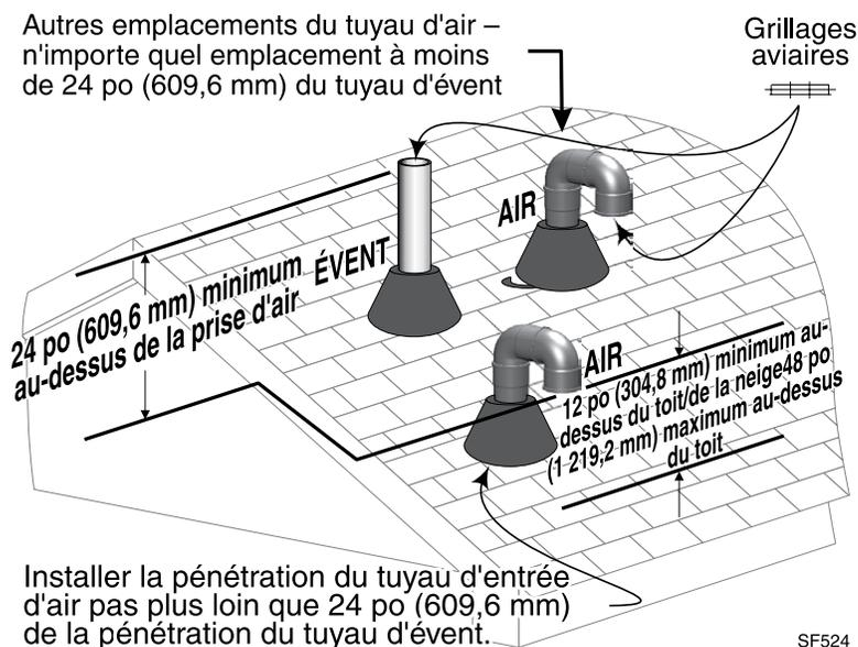
Figure 40 Emplacement de la terminaison – Plusieurs chaudières – Terminaisons verticales de la tuyauterie d'évent et d'air.
