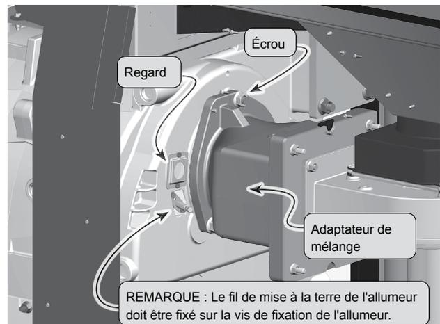
Figure 83 Dépose et remplacement du brûleur
