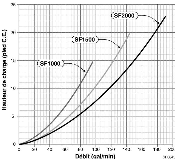
**Figure 12** Dimensionnement des tuyaux recommandé vs débit
