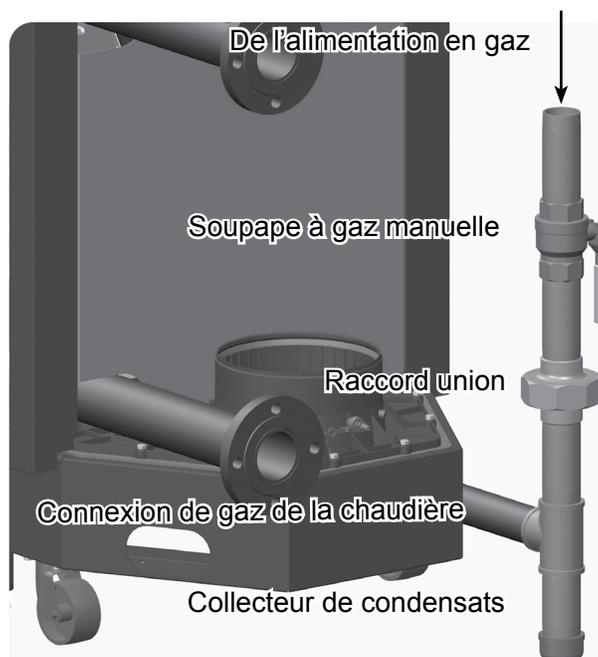
**Figure 47** Prise de pression d'admission de la soupape à gaz (disponible des deux côtés de la soupape à gaz).
