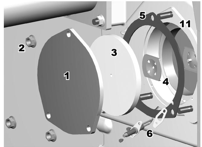
**Figure 85** Assemblage de l'extrémité du brûleur
