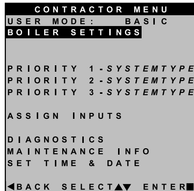
Figure 62 Options RÉGLAGES DE LA CHAUDIÈRE, mode DE BASE SlimFit (le MODE UTILISATEUR doit être réglé sur DE BASE).
