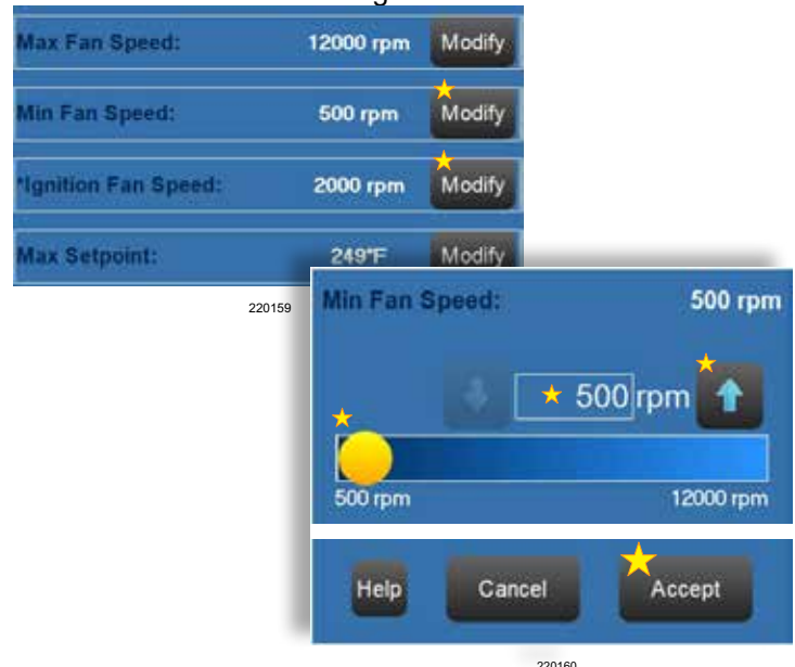
Figure 56 Modification de la vitesse minimum et de la vitesse d'allumage du ventilateur
