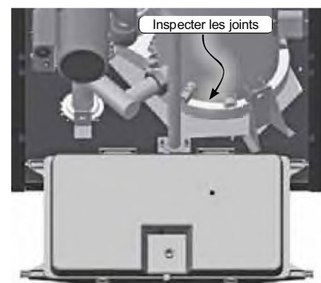
Figure 117 Inspecter les joints de l'échangeur de chaleur au plat à condensat.
