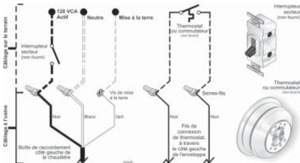
Illustration 27 Connexions de câblage sur le terrain - Interrupteur de secteur et thermostat (ou commutateur) fourni par l'installateur
