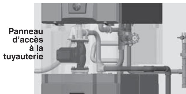
Figure 3 Aligner le chauffe-eau sous la chaudière, comme requis pour que le panneau d'accès à la tuyauterie s'adapte en place
